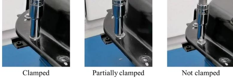
图 8. 套筒与螺钉或电池包表面接触时的三种状态
