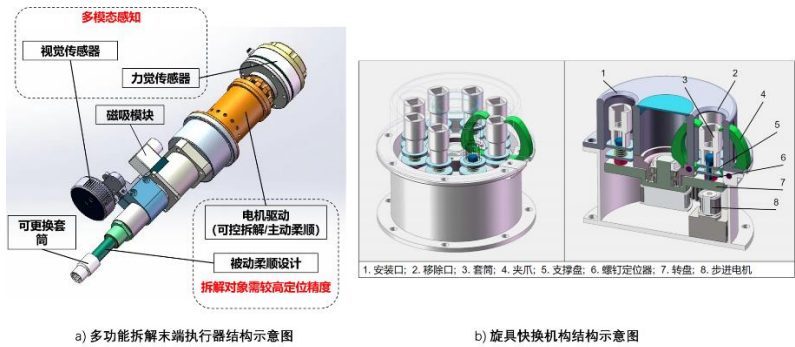
图 10.多功能末端执行器和旋具快换机构
