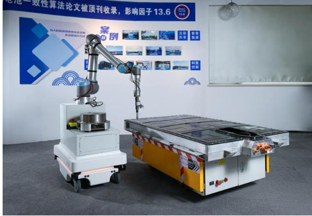
图 5 电池拆卸自主复合型机器人系统 BEAM-1 号
