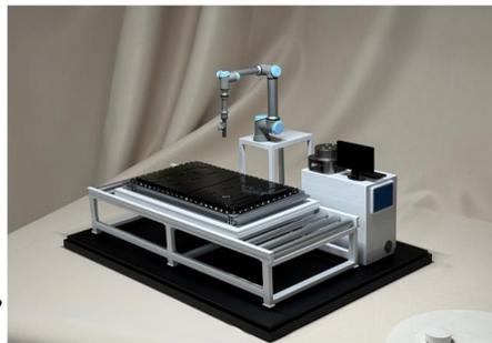
图 4 退役动力电池机器人智能拆解工作站系统
