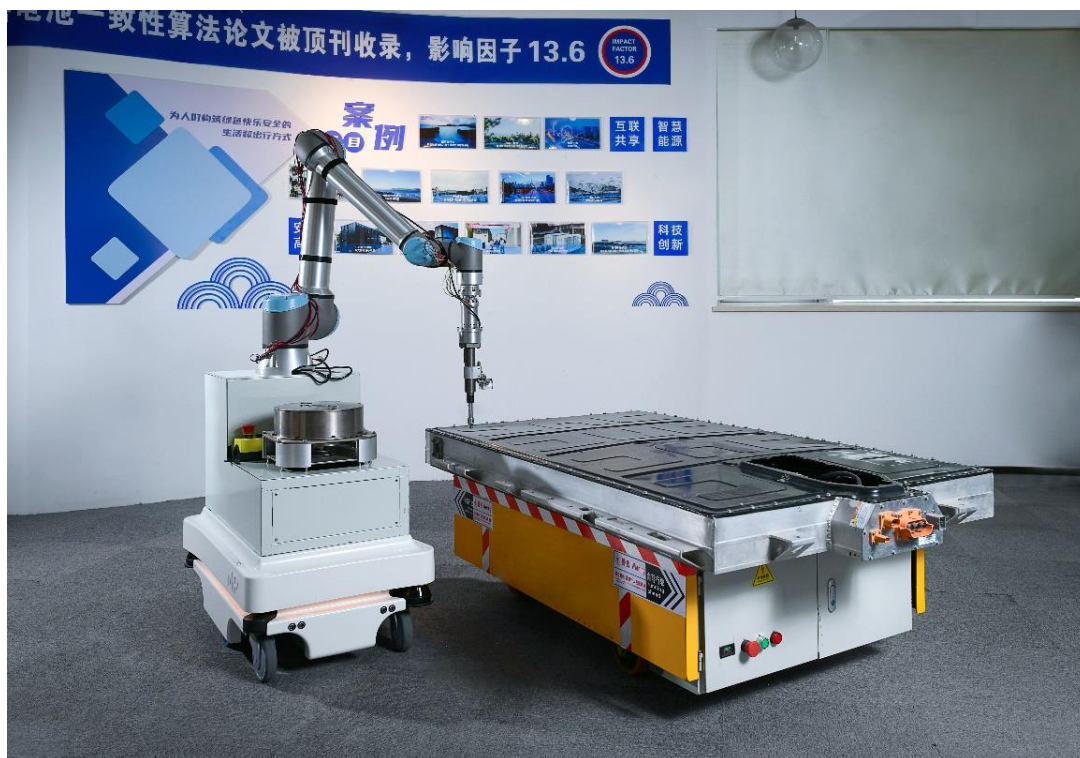
图 3 电池拆卸自主复合型机器人 BEAM-1
