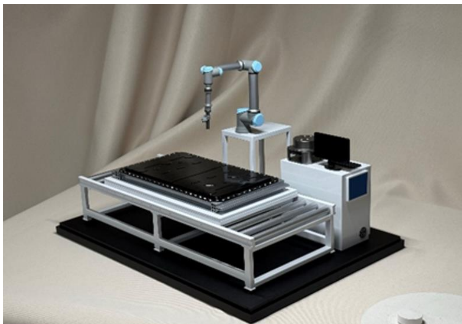
图 7.退役动力电池机器人智能拆解工作站
